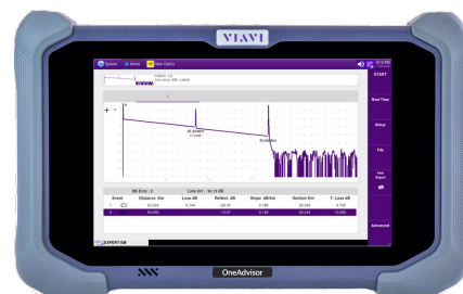
Валидация оптоволоконна с помощью анализатора OneAdvisor
