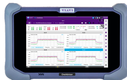
Анализ РЧ-помех от радиointерфейса общего пользования с помощью анализатора OneAdvisor
