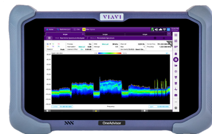
Оценка спектра персистентности в реальном времени с помощью анализатора OneAdvisor
