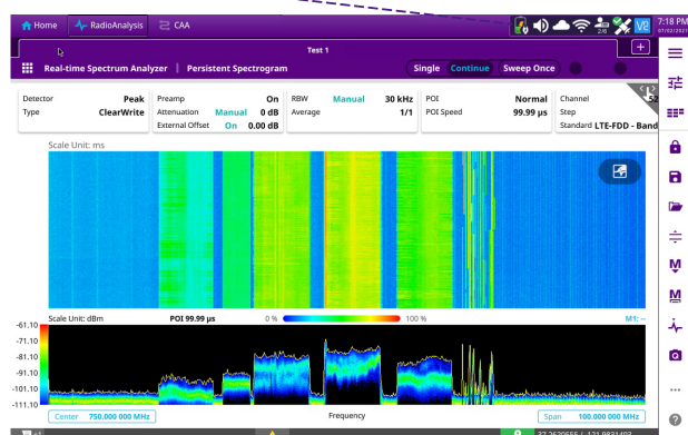
Получение спектрограмм в реальном времени с помощью анализатора OneAdvisor 800
