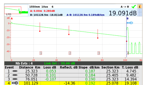
Графическое представление оптоволоконного канала, также называемое рефлектограммой
